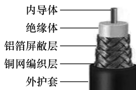
图 2.6 同轴电缆结构
