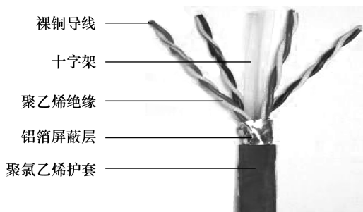
图 2.4 双绞线线缆的结构
