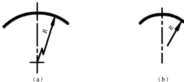
图 1-20 较大半径圆弧的标注
